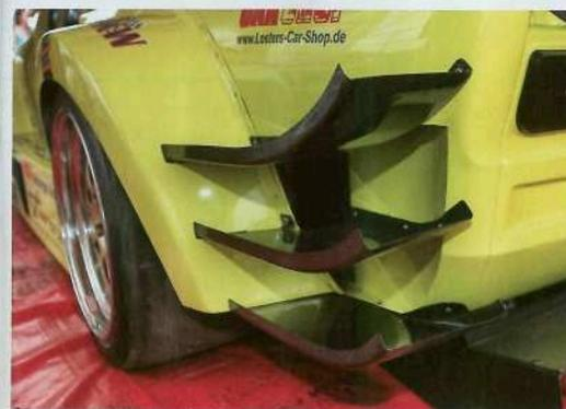
Ausgeklügelte Aerodynamik: die Kotflügelentlüftung
